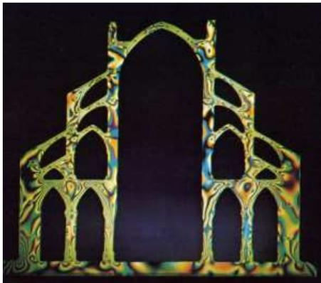
Provino in plexiglass visto in luce polarizzata, Nelle zone deformate o sotto tensione si hanno le modifiche di colore
